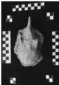
図9. Metashape®での画像処理用の写真を撮影するには対象とする標本の周囲にマーカーを置いて撮影する。
