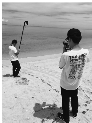
図13. ウミガメ陸上行跡の、一脚を装着した一眼レフカメラによる撮影風景。①カメラ保持係と、②スマートフォンでカメラのファインダー画像を見ながらシャッターを押す係、③カメラの位置を見て保持係に指示する係（②と③は兼務可能）の2～3名がチームになるとよい。
