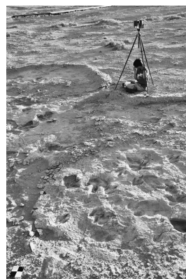
図12. 足跡化石の密集する地層面の 3-D 記録を取得中の 3-D レーザースキャナー。場所を認識させるためのチェッカーボードを置き、一つの露頭面を数力所からレーザースキャンし、画像処理する(モンゴル国ゴビ砂漠シャルツァフ)。
